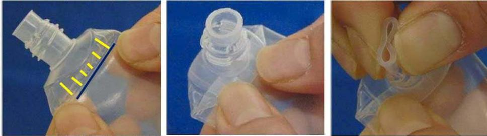
縦方向のリブ(黄線)の剛性で周方向の段差(青線)に応力が集中して折れやすい
